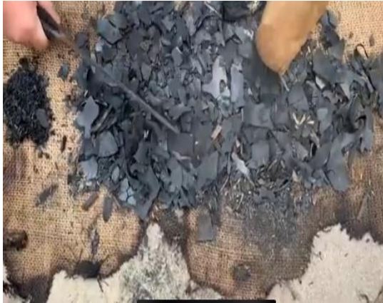
Gambar 3. penghancuran arang batok kelapa
