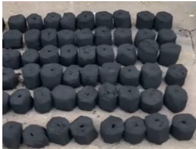
Gambar 5. Briket Batok Kelapa
